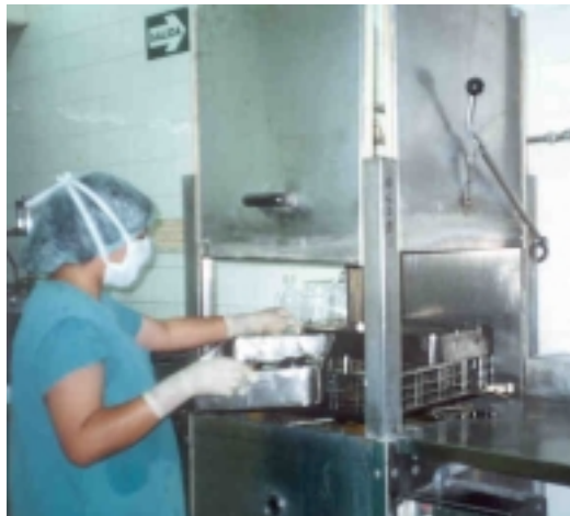
(Fig. No. 2) Las lavadoras descontaminadoras, se utilizan mayormente para el lavado de instrumentales y utensilios.
