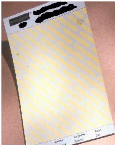
(Fig. No. 21) El test de Bowie Dick son láminas o paquetes especiales que al ser procesadas detectarán fallas de expulsión de aire de la cámara.
