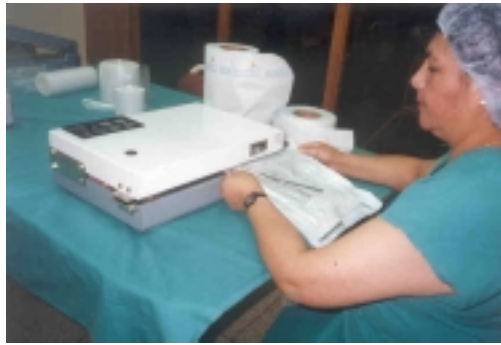
(Fig. No. 16) Se observa una selladora automática, para los empaques mixtos (Seal and peel)
